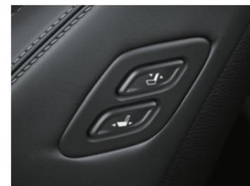
Дополнительный блок управления регулировками переднего пассажирского сиденья.
