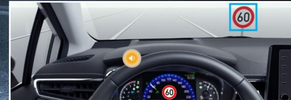
СИСТЕМА РАСПОЗНАВАНИЯ И ИНФОРМИРОВАНИЯ ВОДИТЕЛЯ О ДОРОЖНЫХ ЗНАКАХ ОТОБРАЖАЕТ ИХ НА ПРИБОРНОЙ ПАНЕЛИ, ОДНОВРЕМЕННО ОПОВЕЩАЯ ВОДИТЕЛЯ ЗВУКОВЫМ СИГНАЛОМ.
