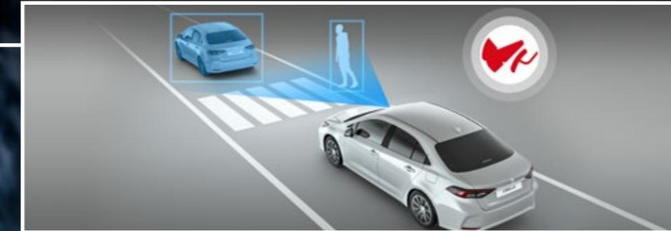
СИСТЕМА ПРЕДУПРЕЖДЕНИЯ ОБ УГРОЗЕ ФРОНТАЛЬНОГО СТОЛКНОВЕНИЯ С ФУНКЦИЕЙ АВТОМАТИЧЕСКОГО ТОРМОЖЕНИЯ И РАСПОЗНАВАНИЯ ПЕШЕХОДОВ СОВЕРШАЕТ АВТОМАТИЧЕСКУЮ ЭКСТРЕННУЮ ОСТАНОВКУ ПРИ ВЫЯВЛЕНИИ УГРОЗЫ.
