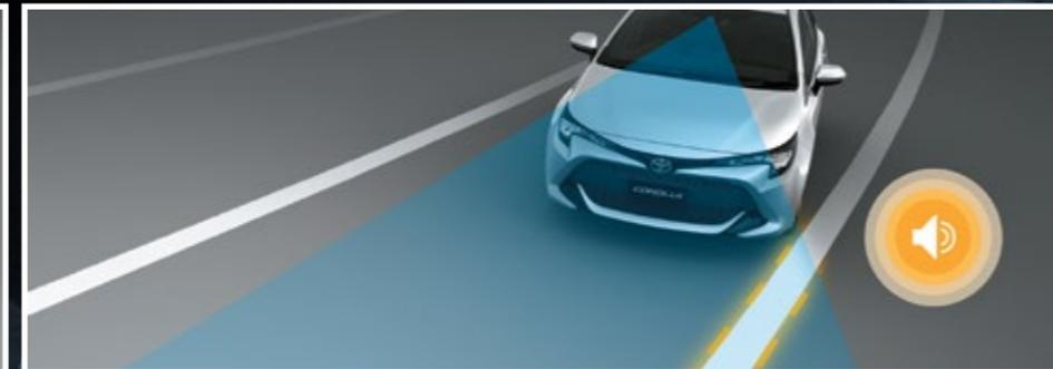
СИСТЕМА ОПОВЕЩЕНИЯ О НЕПРЕДНАМЕРЕННОМ ПЕРЕСЕЧЕНИИ ДОРОЖНОЙ РАЗМЕТКИ С ФУНКЦИЕЙ ВОЗВРАТА В ПОЛОСУ ОПОВЕЩАЕТ О ВЫЕЗДЕ ЗА ПРЕДЕЛЫ ПОЛОСЫ ДВИЖЕНИЯ И ПОДРУЛИВАЕТ ДЛЯ ВОЗВРАЩЕНИЯ АВТОМОБИЛЯ ОБРАТНО В СВОЙ РЯД.
